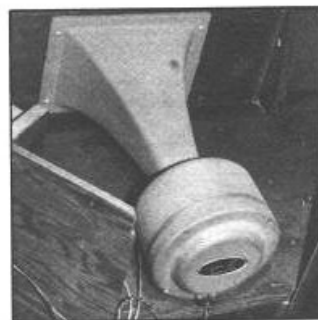
Chambre de compression médium 375, première version avec pavillon sectoriel. Le filtre de répartition LX500 se situe à gauche dans son logement.
